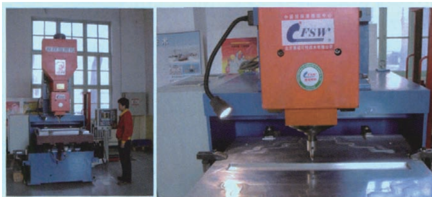
图4 台式平面曲线搅拌摩擦焊设备及产品
