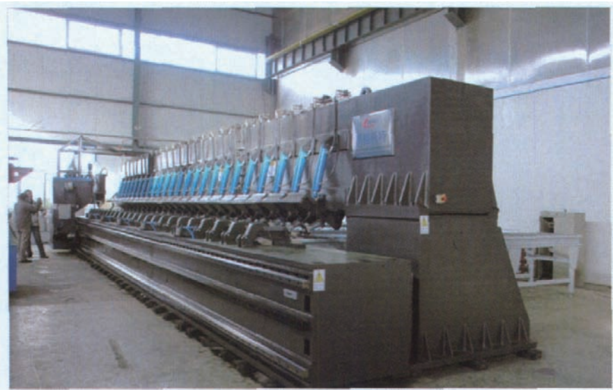
图2 宽幅型材壁板拼接搅拌摩擦焊设备
