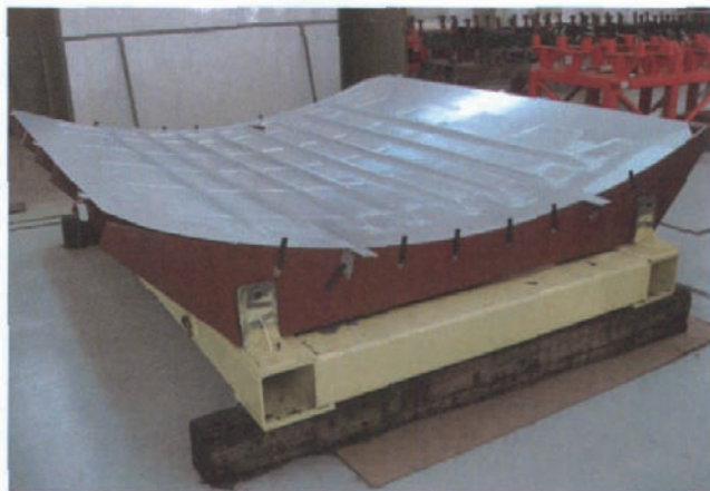
图1 平直对接搅拌摩擦焊制造飞机带筋壁板
