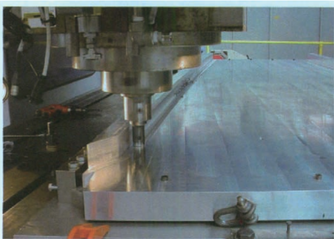
图7 空客A340机翼搅拌摩擦焊结构件
