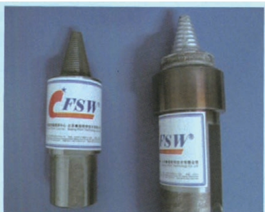
图8 中国搅拌摩擦焊中心研制的大厚度搅拌摩擦焊工具
