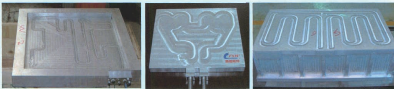
图3 中空散热器结构平面曲线搅拌摩擦焊制造
